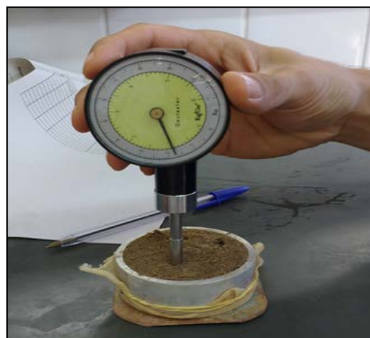
Figura 5. Demonstração da avaliação de resistência do solo a compactação com a utilização de penetrômetro de bolso.
