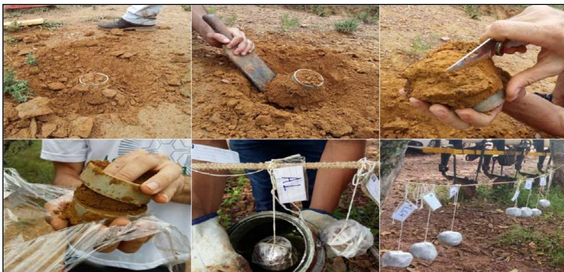
Figura 4. Etapas da coleta de amostras de solo indeformadas.
