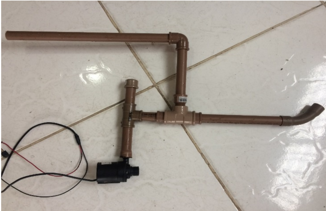
Figura 6. Tubulação do aerador.
