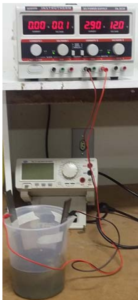
Figura 1. Montagem do reator eletroquímico para eletrofloculação da água de lavagem do biodiesel.
